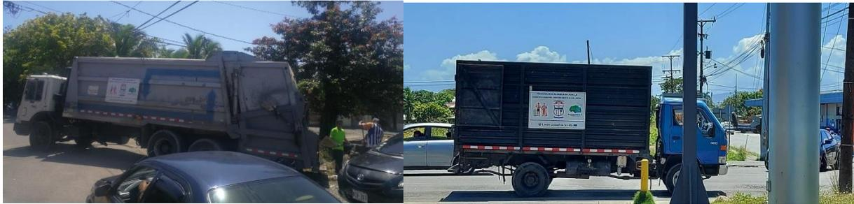
Fotografía 22: La imagen de la de izquierda muestra los camiones compactadores utilizados por la Municipalidad de Limón. La imagen de la derecha muestra los camiones utilizados para brindar servicio en las calles a las que los camiones compactadores no pueden acceder.
