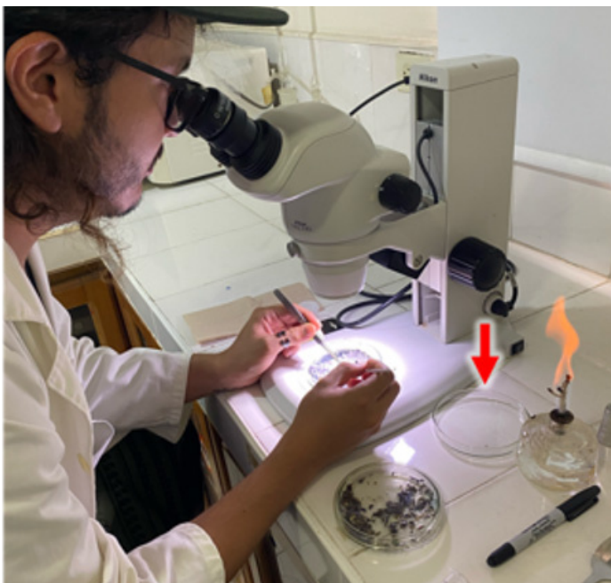
Fotografía 33. Observación de muestras de microplásticos en el estereoscopio.
