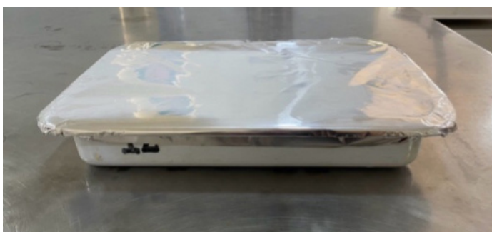
Fotografías 30 y 31. Secado de muestras en horno empleando bandejas metálicas y posterior almacenamiento con cobertura de aluminio.
