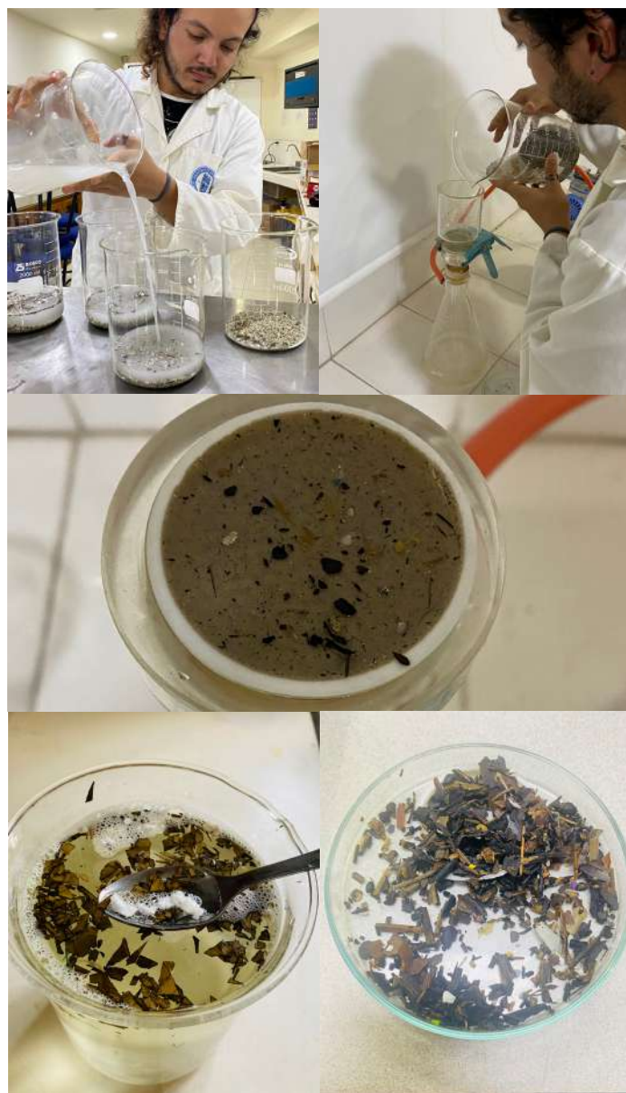
Fotografía 34. Proceso de separación por densidades empleando cloruro de calcio (1.45 g/cm 3 ) seguido de la filtración e inspección visual
