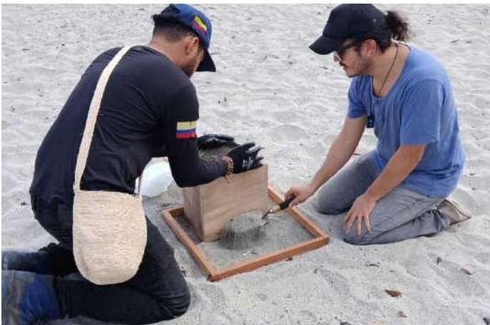
Fotografía 24. Recolección de arena o sedimento de playa para el análisis de microplásticos y mesobasuras
