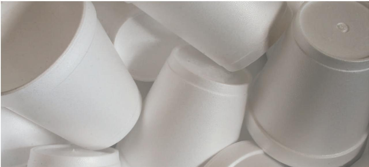
El foam es altamente ligero y puede soportar muchas veces su propio peso en el agua debido a que sus celdas no están interconectadas. De igual forma, el calor no atraviesa el foam con facilidad, lo que lo convierte en un buen aislante y es por eso que se utiliza para bandejas de comida, tazas de café, entre otras. Ligereza y gran capacidad de adaptación son las dos características de los envases de foam que han supuesto un reto en la gestión de sus residuos.
